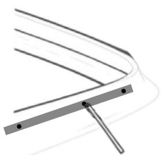
С помощью пробойника (шило, отвертка), в местах крепления рамки, делаем отверстия в уплотнителе, чтобы предотвратить налипание на винты клеевой основы.
